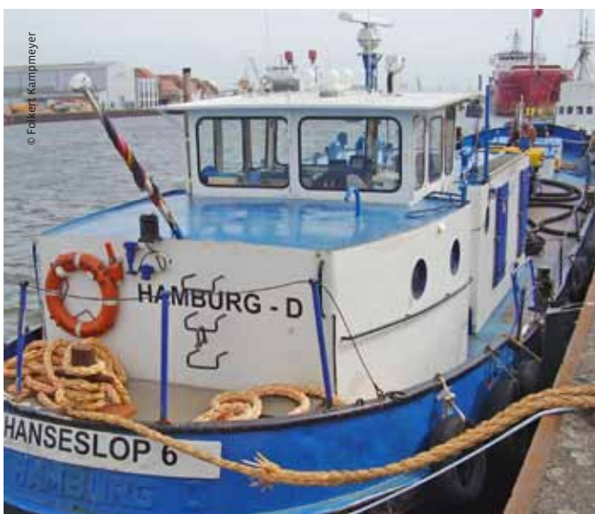
In Bremerhaven hat die „Hanseslop 6“ ihren Liegeplatz. Die Tankbarge verfügt über eine Ladekapazität von knapp 100 Kubikmetern, verteilt auf 4 Laderäume.
